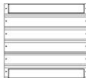
WP6 | PANNEAU CENTRAL GAUCHE - W2A03861 (x1) 1 1/4 po x 18 7/8 po x 20 7/8 po (32 x 478 x 536)
